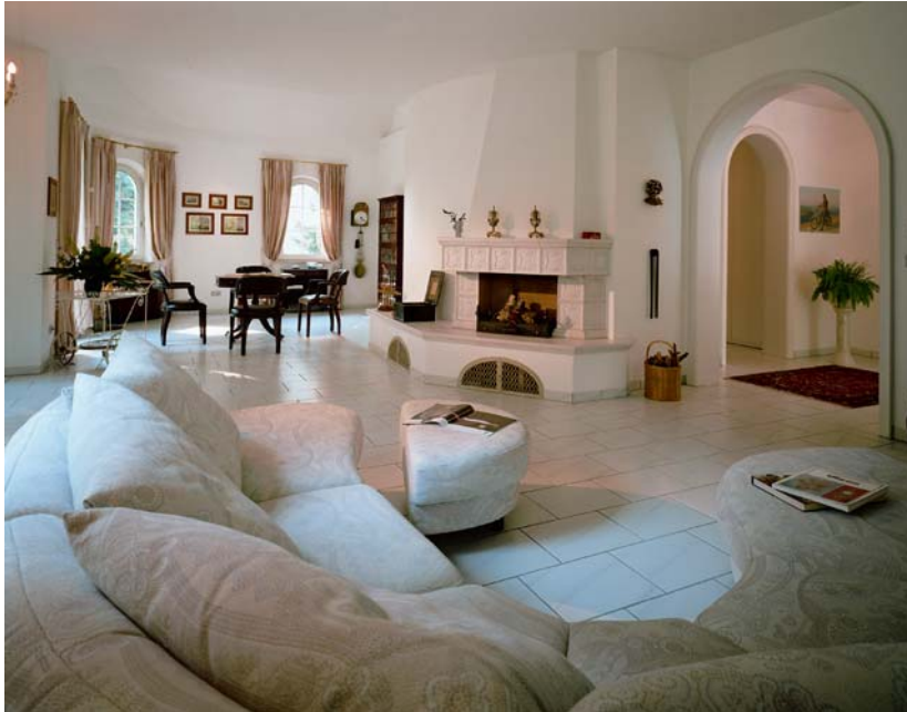
Bild 7: Mit Porenbeton verkleideter und abgemauerter Kachelofen in einem Wohnraum
