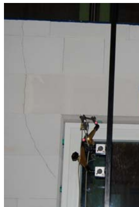
Bild 3: Statische Druckbelastung der Verriegelungspunkte und Rissbildung in der Wanddecke
