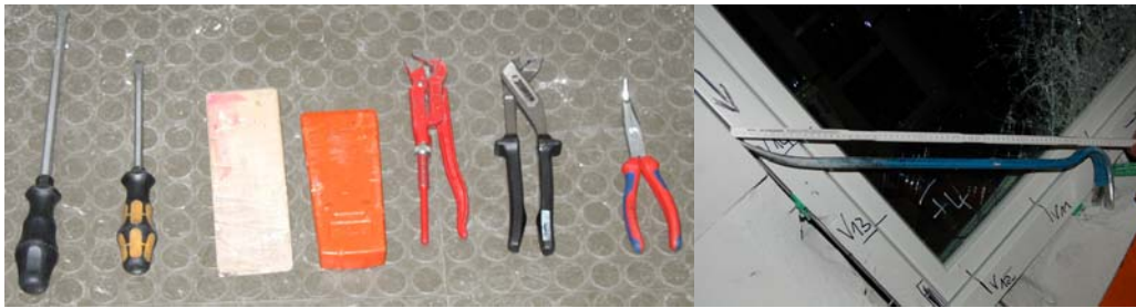
Bild 5: Im Rahmen der WK 2-Prüfung verwendeter Werkzeugsatz und zusätzlicher Kuhfuß
