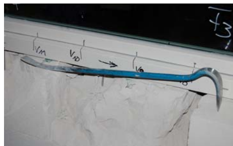
Bild 7: Versuch, innerhalb von 5 Minuten mit dem Kuhfuß direkt durch die Wand zu brechen
