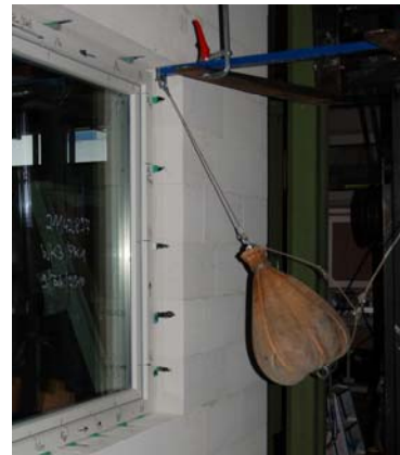
Bild 4: Dynamischer Versuch mit einem Sandsack (30 kg)
