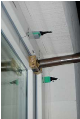
Bild 3: Statische Druckbelastung der Verriegelungspunkte und Rissbildung in der Wanddecke
