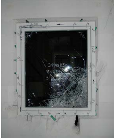
Bild 8: Geprüftes Fensterelement und Porenbetonwand nach über 30 Minuten manueller Prüfung an verschiedenen Angriffsstellen
